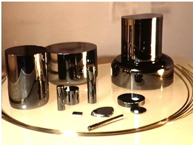
Fig. 1 Lingots et fibres optiques de verres de chalcogénures
